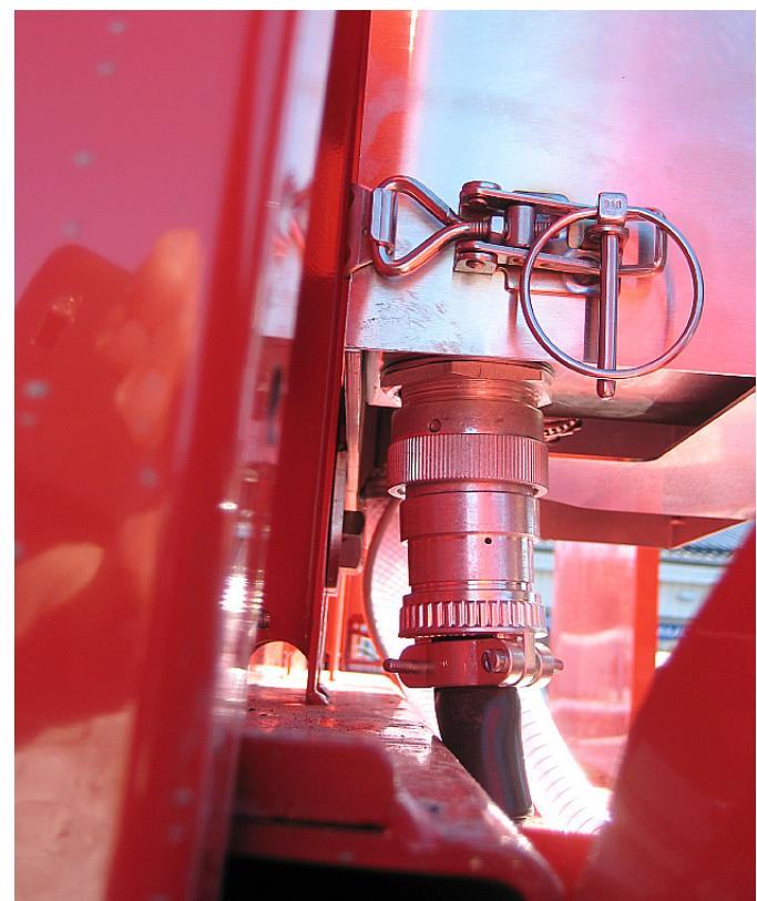
Bild 100. Montering av styrsystemkabeln
