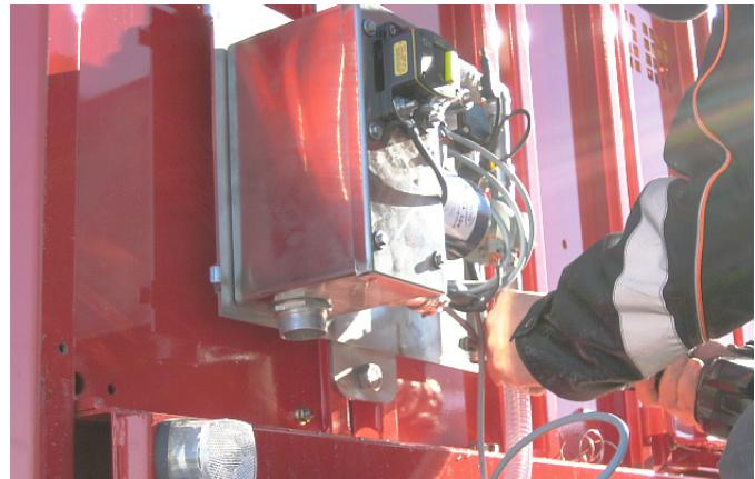
Bild 75. Sugrörens fästning till pumpens sugsida
