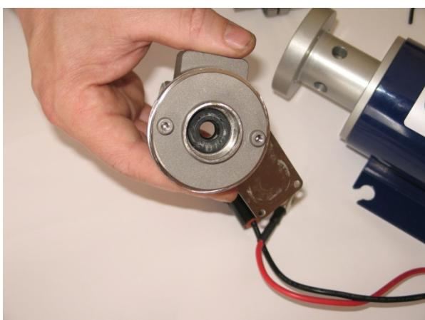
Bild 47 Lagerhustätning
