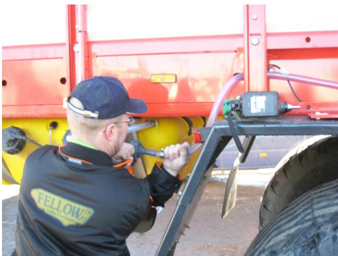
Bild 72. Kopplingen av sugslang till filterhus
