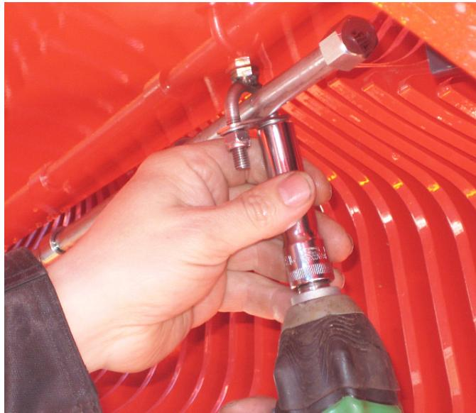
Bild 88. Montering av munstycksröret
