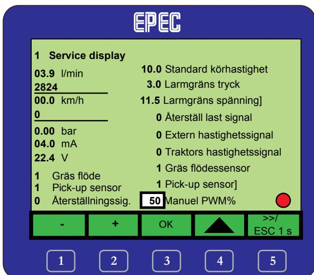
Bild 10 Förförändringen på setup i Service display
