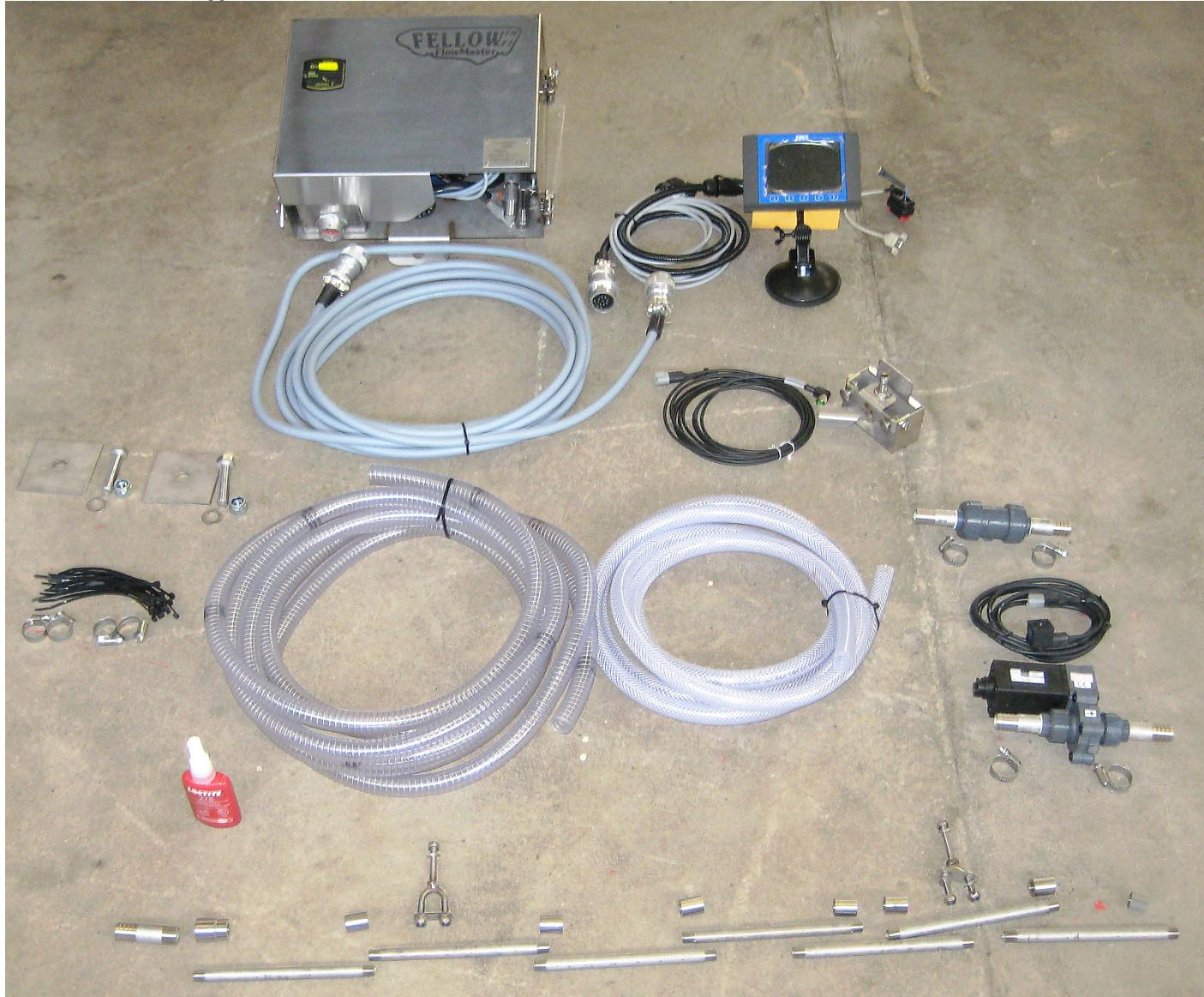
Bild 67. Innehållet till FlowMaster PROFI monteringssats
