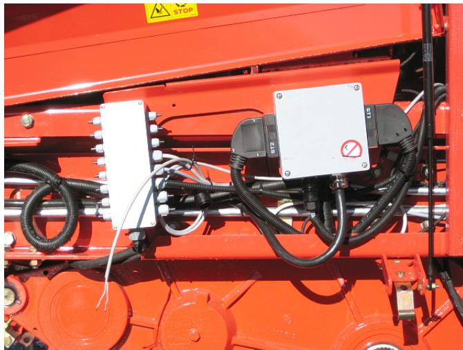
Bild 77. Elektrisk kopplingsdosa och signalledning
