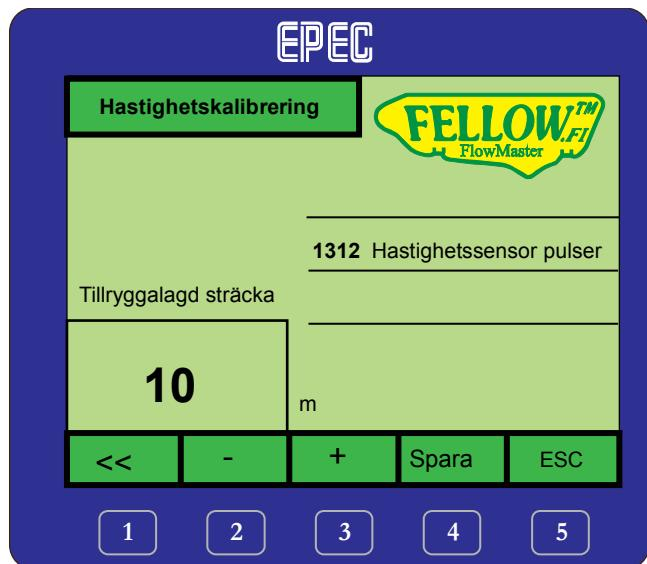
Bild 22 Lagring av hastighetssignalens kalibrering
