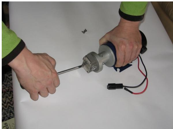
Bild 38 Lossning av pumpens lock
