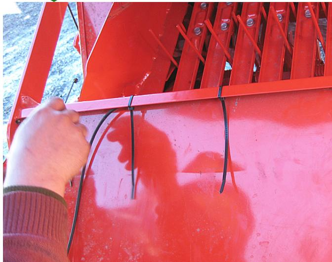
Bild 96. Fästning av givarens ledning
