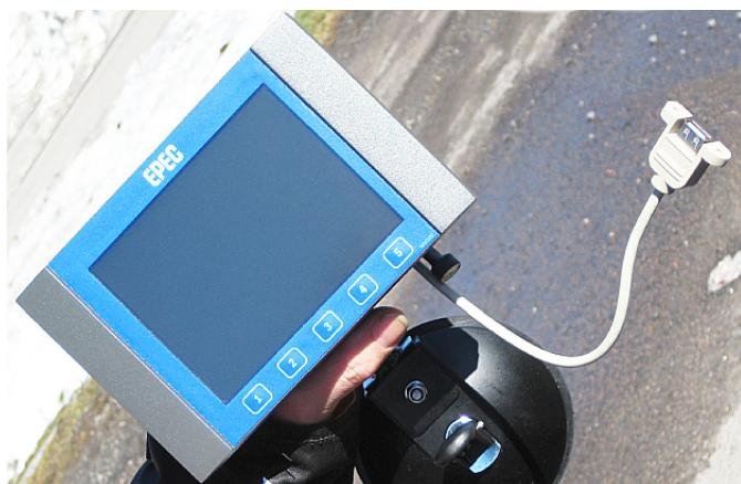
Bild 102. Epec 2040 CoDeSys display
