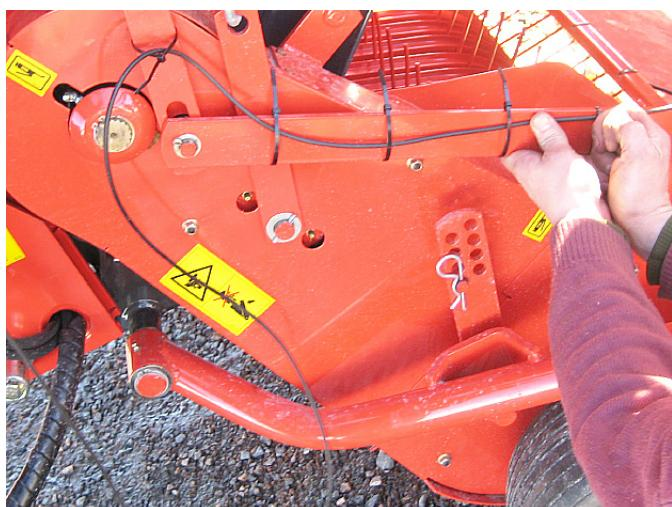
Bild 97. Fästning av givarens ledning
