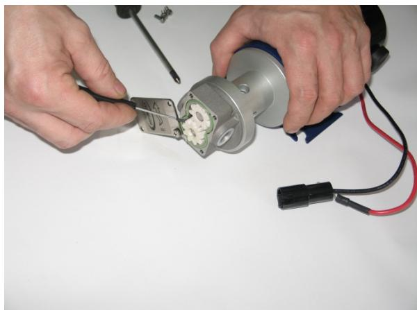
Bild 39 Losstagning av kugghjul
