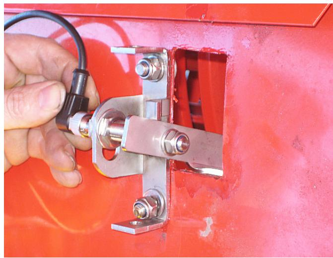
Bild 93. Kopplingen av foderflödesgivare
