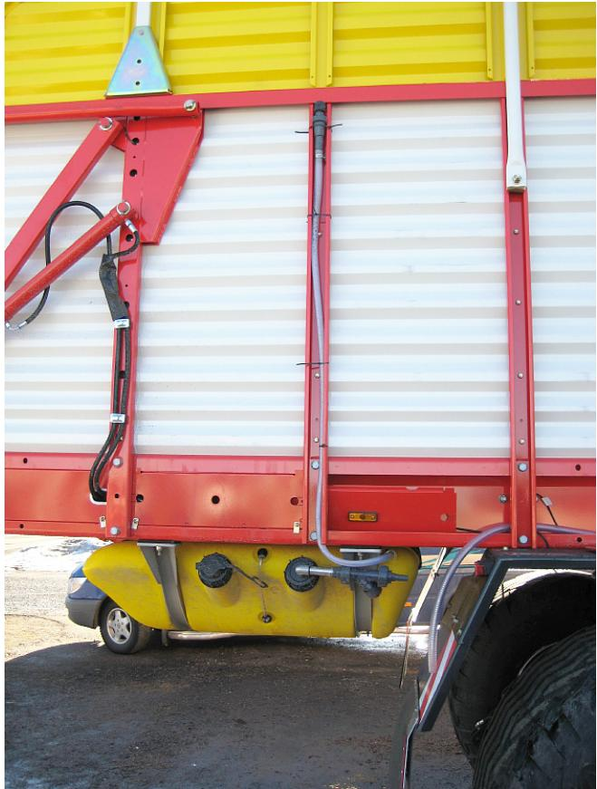
Bild 70. Ventileringssläng
