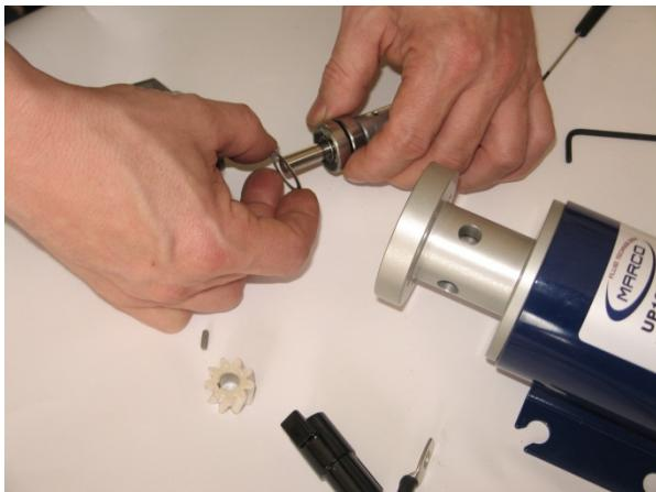
Bild 46 Losstagnig av lagertätningar
