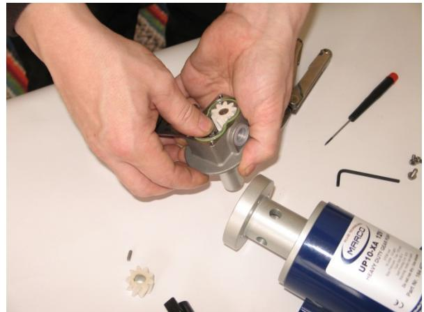
Bild 44 Losstagnings av axel
