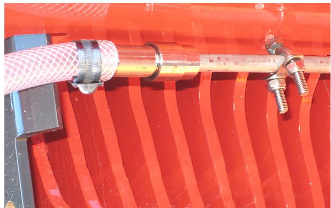
Bild 89. Montering av munstycksröret
