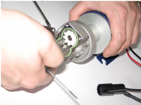
Bild 41 Losstagnings av kil
