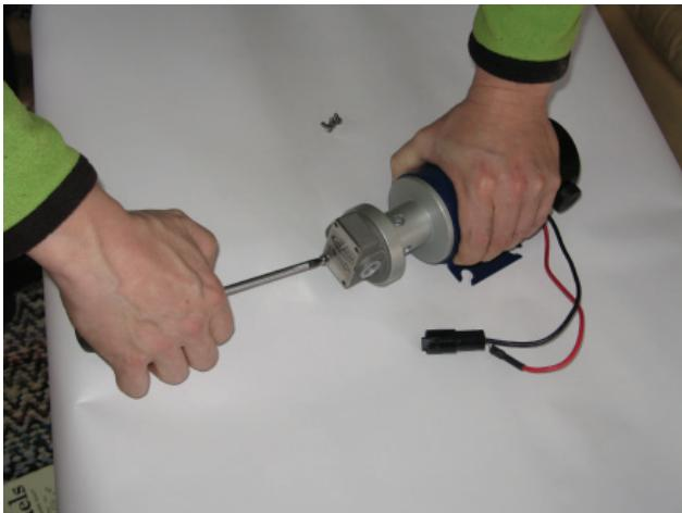
Bild 33. Lossning av pumpens lock
