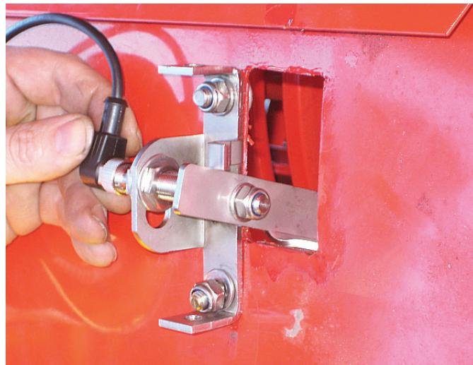
Bild 93. Kopplingen av foderflödesgivaren
