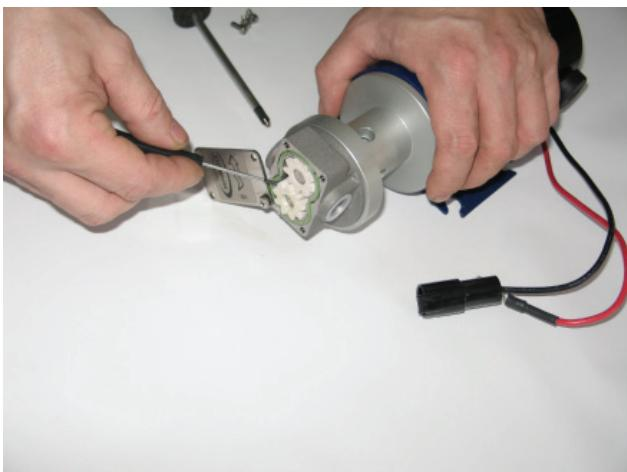
Bild 34. Losstagnings av kugghjul
