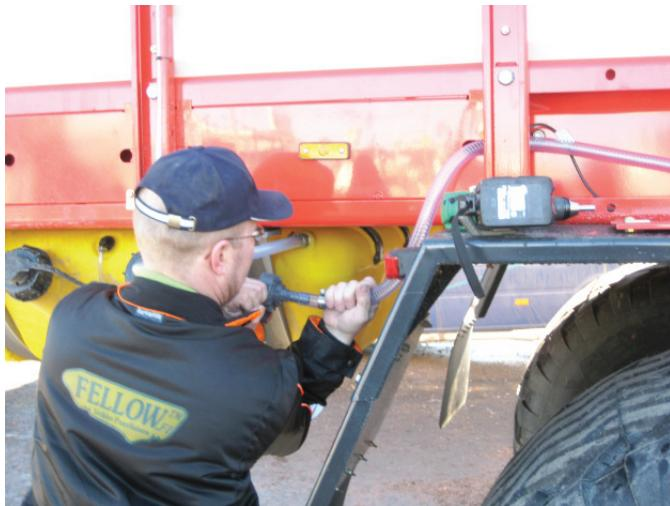
Bild 66. Kopplingen av sugslang till filterhus
