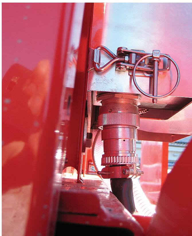
Bild 101. Fästning av styrsystemkabeln
