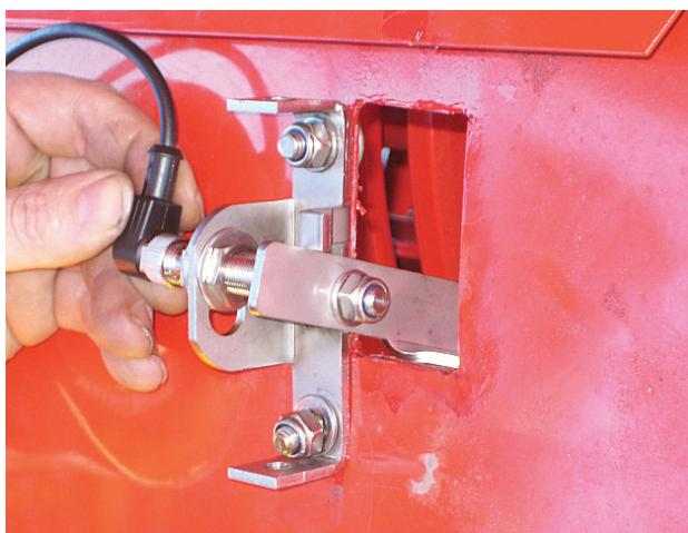
Bild 24. Foderflödesgivare
