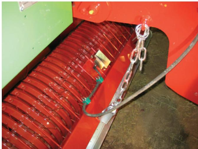
Bild 96. Foderflödesgivarens ledning och skydd
