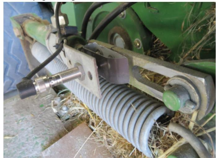
Bild 79. Balpressens signalledning (extra utrustning)
