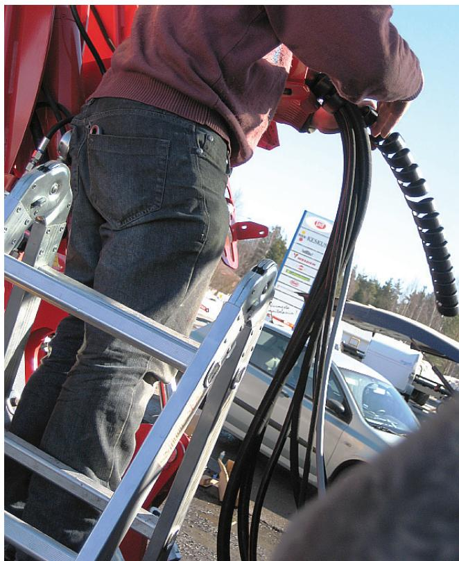
Bild 102. Lösning av skyddsspiralen
