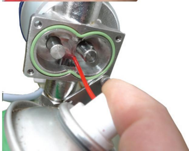
Bild 31. Pumpens smörjning
