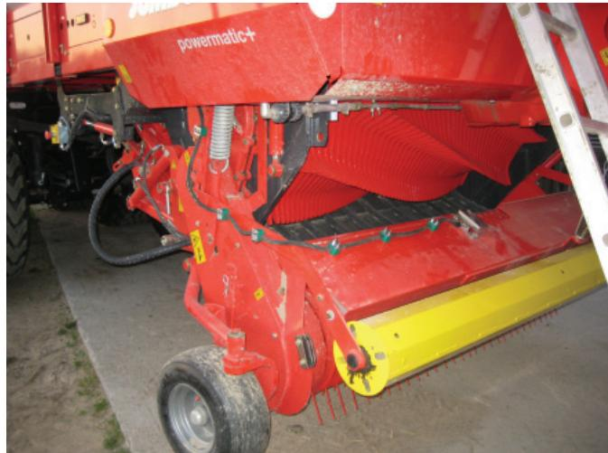
Bild 97. Foderflödesgivarens ledning och skydd
