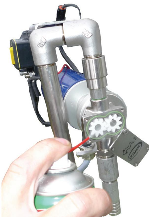
Bild 29. Pumpens smörjning
