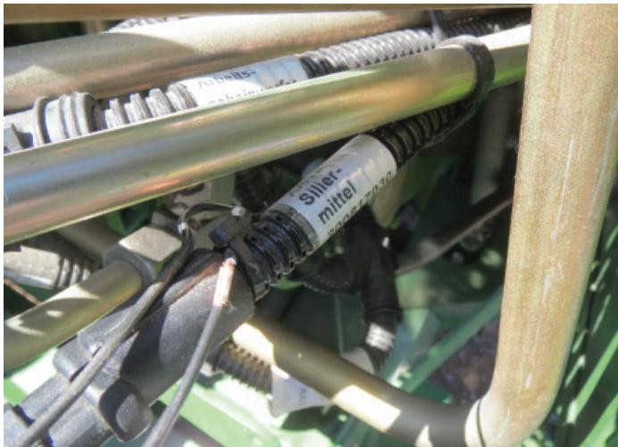
Bild 76. Signalledningen (Krone, XA1a Siliermittel)
