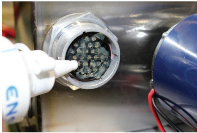
Bild 80. Smörjning av anslutningarna före montering.
