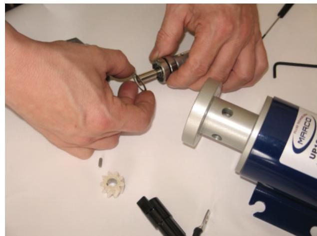
Bild 41. Losstagningsprocessen av lagertätningar
