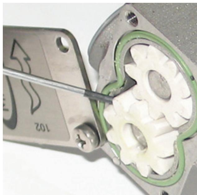
Bild 35. Lossa kugghjul från kugghjuls gap
