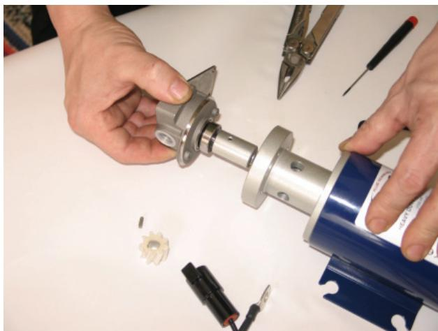
Bild 38. Losstagningsprocessen av huset och axeln
