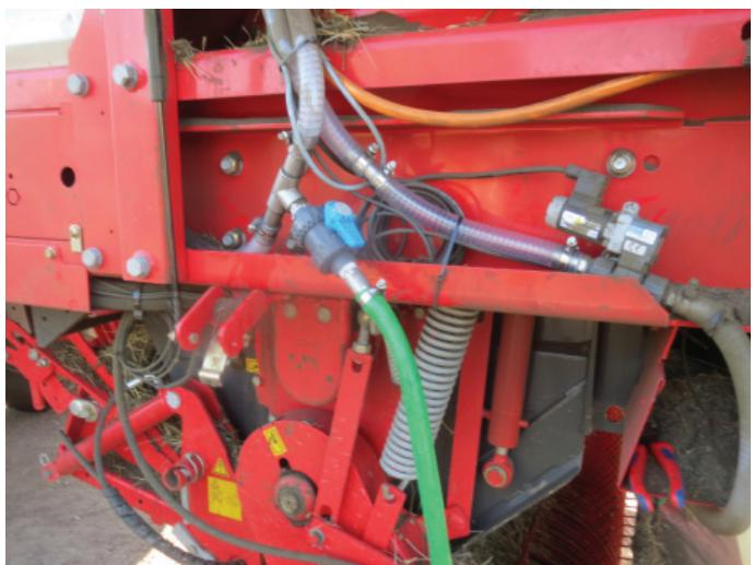
Bild 107. T-gren monterad
