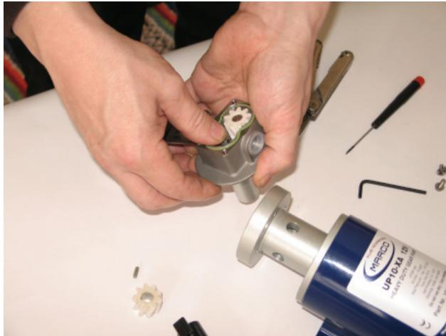
Bild 39. Losstagningsprocessen av axeln
