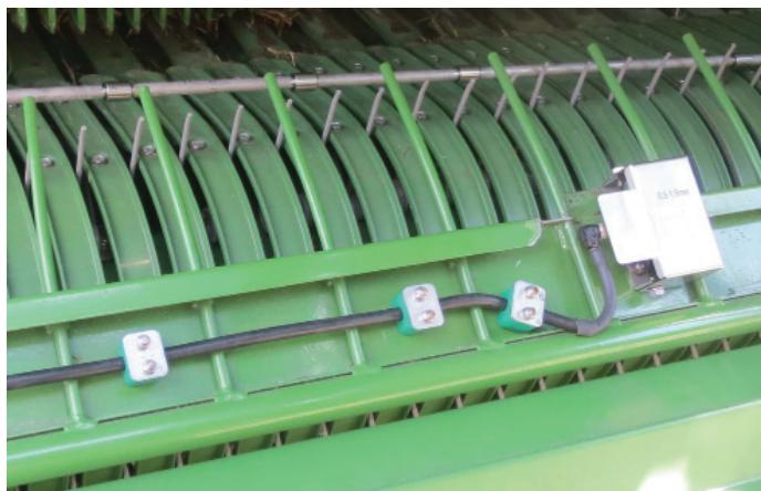
Bild 98. Foderflödesgivarens ledning och skydd
