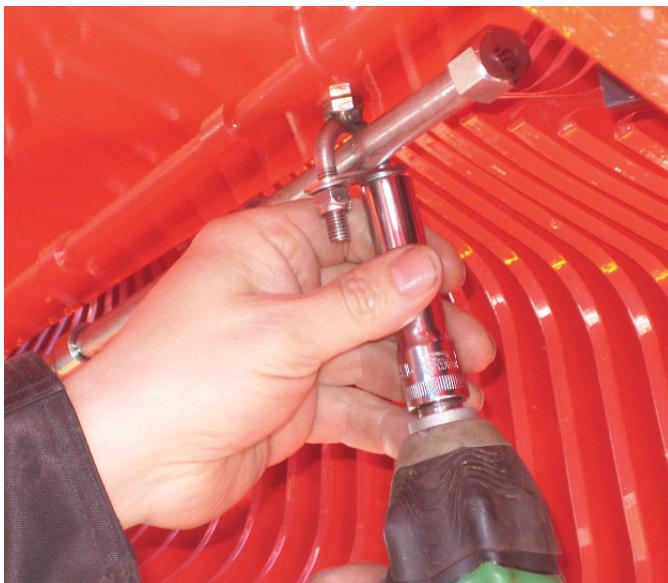
Bild 88. Montering av munstycksröret
