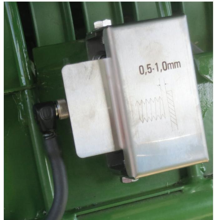
Bild 94. Foderflödesgivare med kåpan
