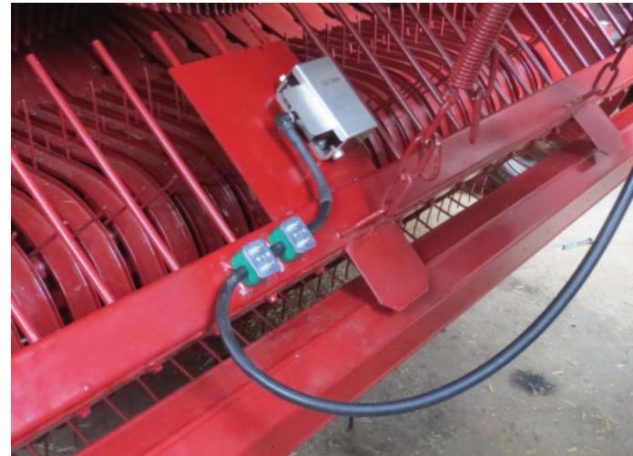
Bild 100. Foderflödesgivarens ledning och skydd
