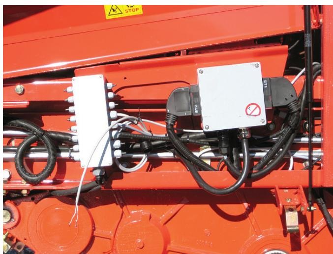
Bild 71. Elektrisk kopplingsdosa och signalledning
