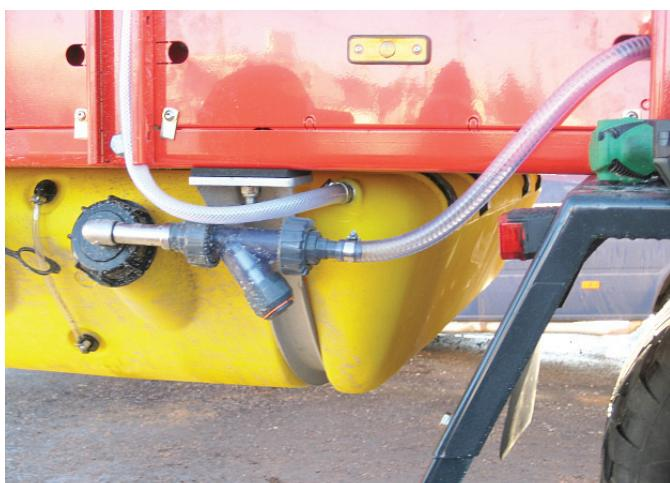
Bild 68. Kanternas slipning i slangen genomföring
