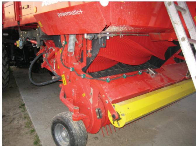
Kuva 97. Rehuvirtausanturin johto ja suojuus
