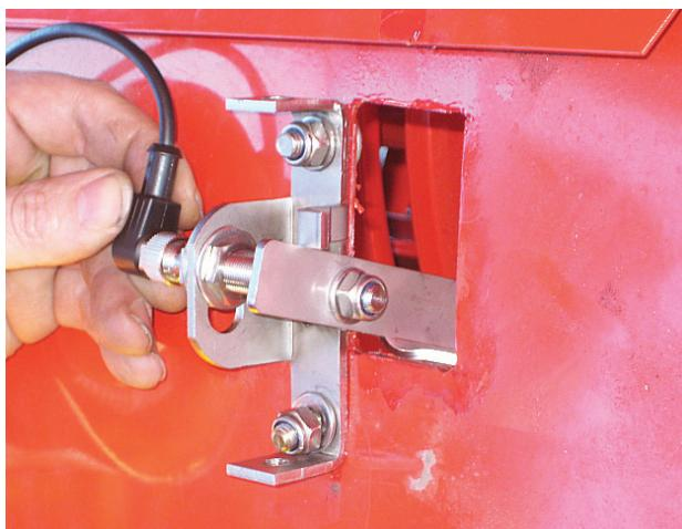
Kuva 24. Rehuvirtausanturi
