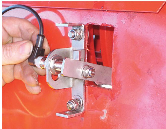
*Kuva 93. Rehuvirtausanturin kytkeminen*
