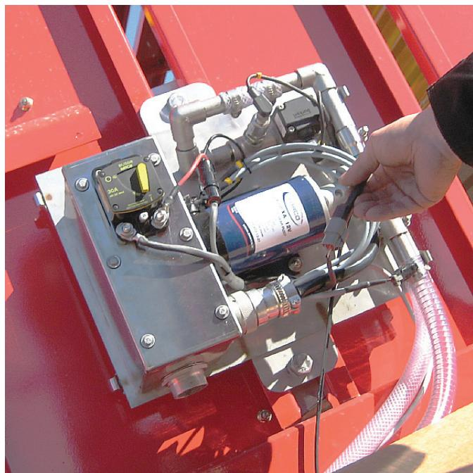
Kuva 90. Rehuvirtausanturin johtimen kytkentä
