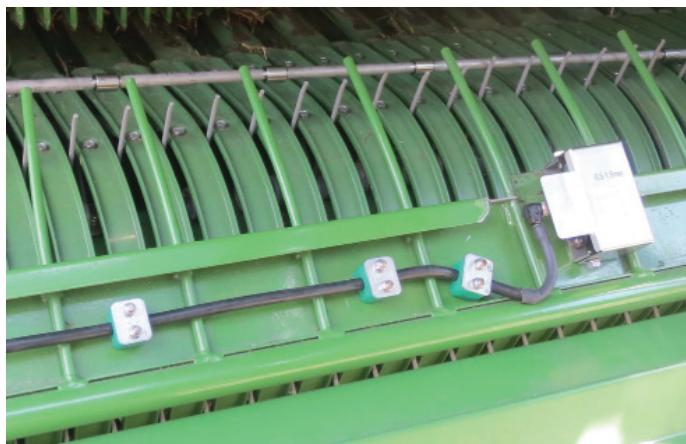
Kuva 98. Rehuvirtausanturin johto ja suojuus
