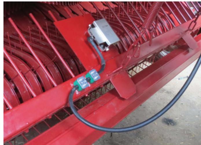
Kuva 100. Rehuvirtausanturin johto ja suojuus
