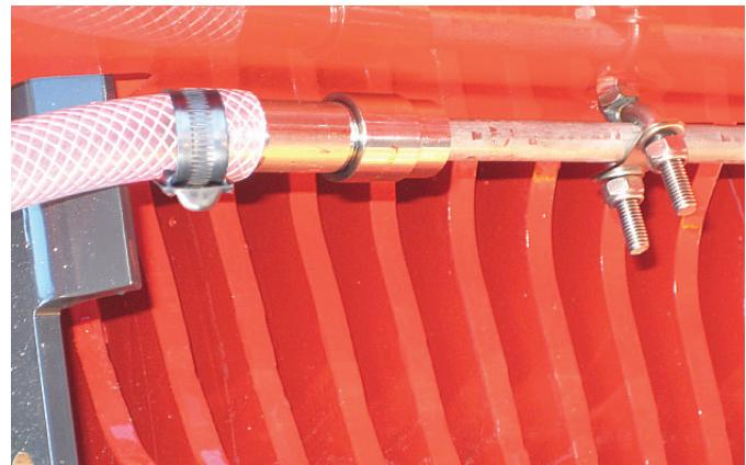
Kuva 89. Suutinputken asennus
