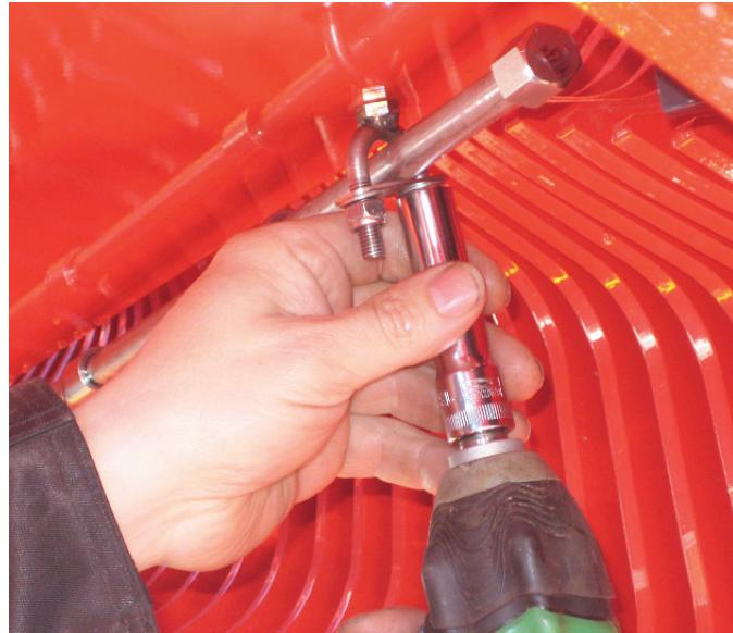
Kuva 88. Suutinputken asennus
