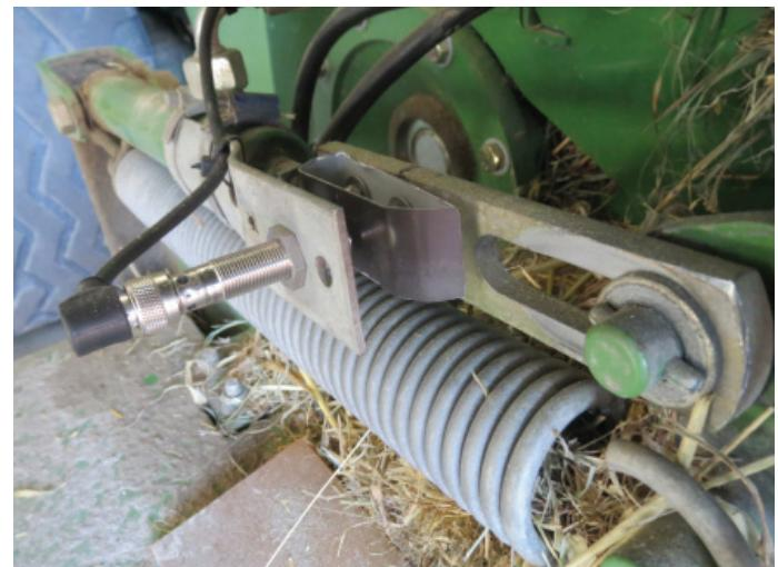
Kuva 79. Paalaimen anturi (lisävaruste)
