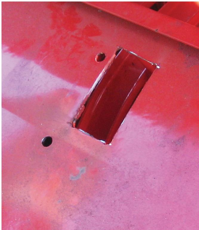
*Kuva 92. Rehuvirtausanturin asennus*
