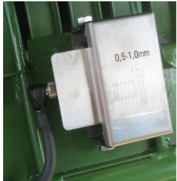
*Kuva 94. Rehuvirtausanturi koteloineen*
