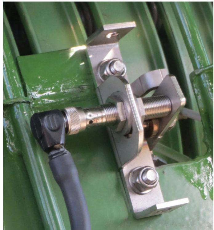
Kuva 99. Rehuvirtausanturi
